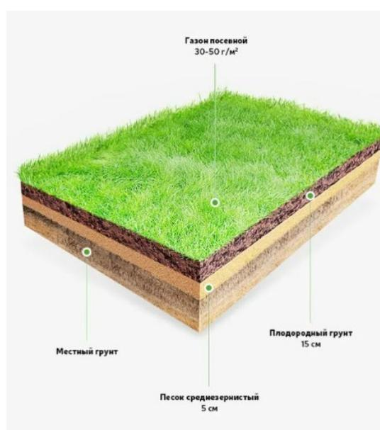
Рисунок 37. Конструкция эксплуатируемого газона.
